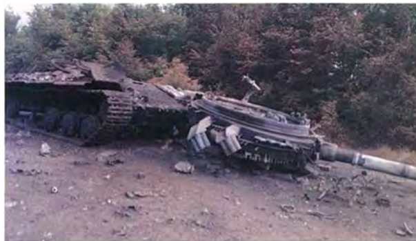
Рисунок 1.2.2 – Т-64БВ після проїзду над міною ТМ-89, днище пробито кумулятивним струменем, від якого здетонував бойовий комплект, який зірвав башту танку з погону.
