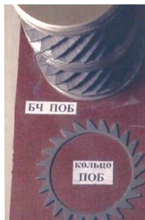
Рисунок 2.13.2 - сталеві кільця міни ПОБ, з яких, при підриві утримуються осколки.
