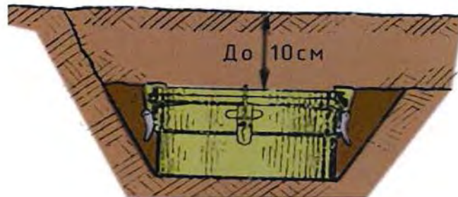
Рисунок 3.4.2 – встановлення міни МЛ-1 в ґрунті.
