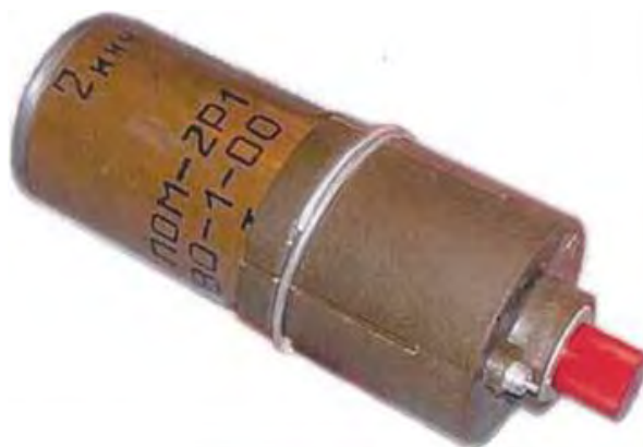
Рисунок 2.12.2 – міна ПОМ-2Р1, вставлена в пристрій УРП.
