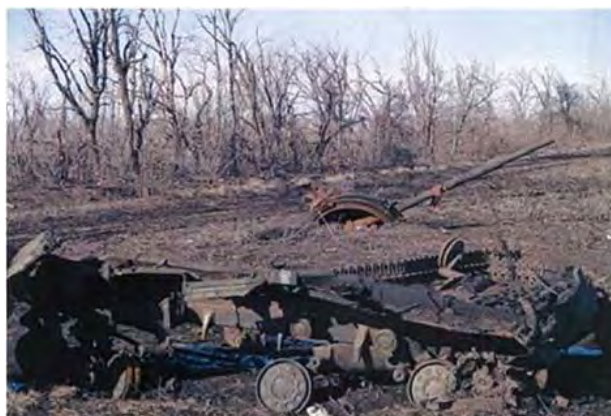
Рисунок 1.2.3 – Т-64Б після проїзду над міною ТМ-89, від детонації бойового комплексу корпус розірвано, башта відкинута на 20 м ліворуч від танка.
