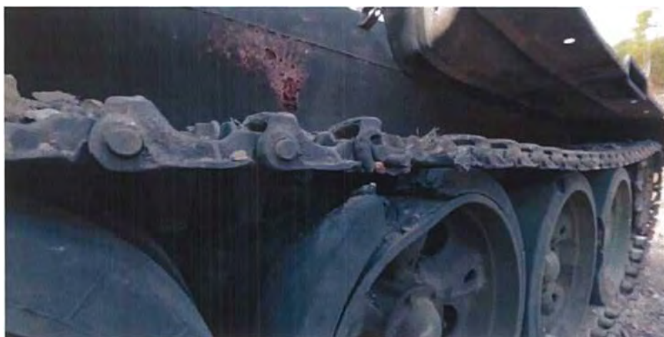
Рисунок 1.5.6 – дія ТМ-83: пошкоджено каток, гусеницю, борт не пробито, тому що УЯ попало в трак і роздвоїлось, знизивши силу пробиття.
