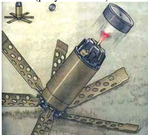
Рисунок 2.10.5 - міна ПОМ-2, відстріл кришки та розкриття підпружинених лап.
