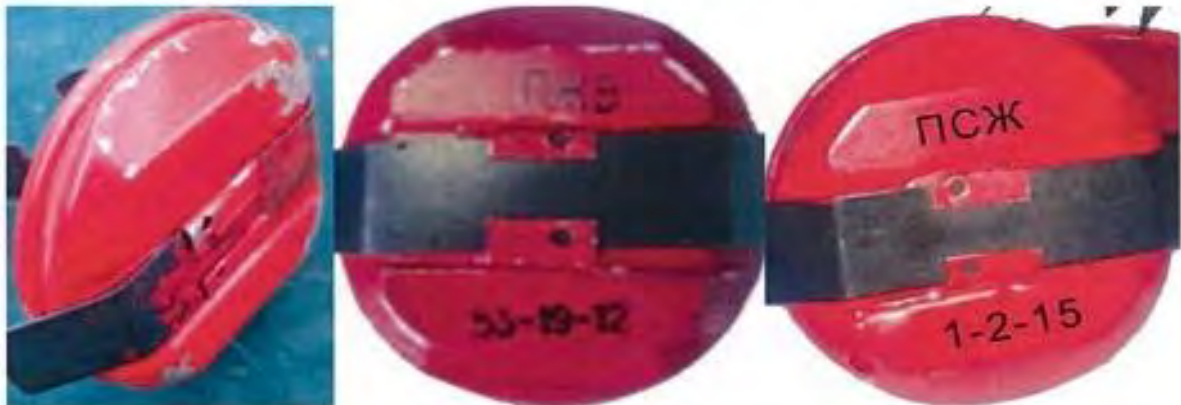
Рисунок 4.7.1 – зліва: залізнична петарда випуску до 2008 року; в центрі і справа: випуску після 2008 року.
