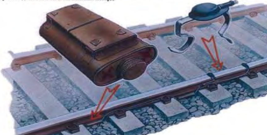
Рисунок 4.7.3 – Петарда в якості детонатора протитранспортної міни.
