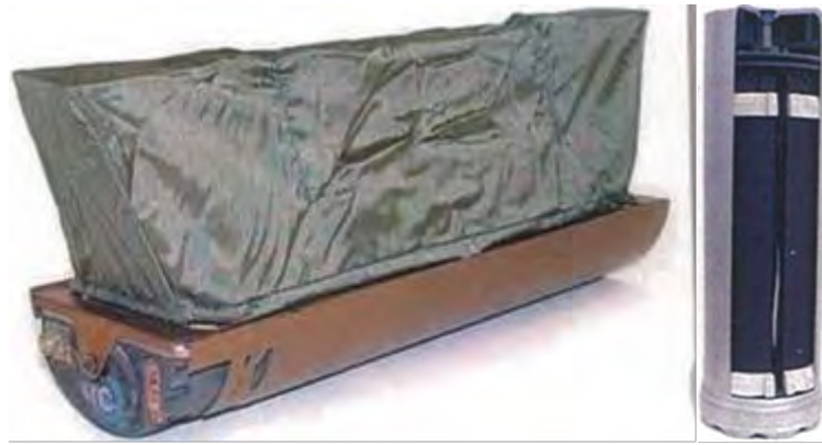
Рисунок 1.3.1 – Зліва: Міна ПТМ-4 з підпружинним тканинним чохлам. Справа: Касета КПТМ-4, загальний вигляд в розрізі.
